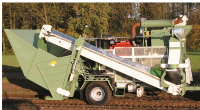
Billede 1. Stor hammermølle til formaling af korn og kernemajs. Foto: Willemsen.
